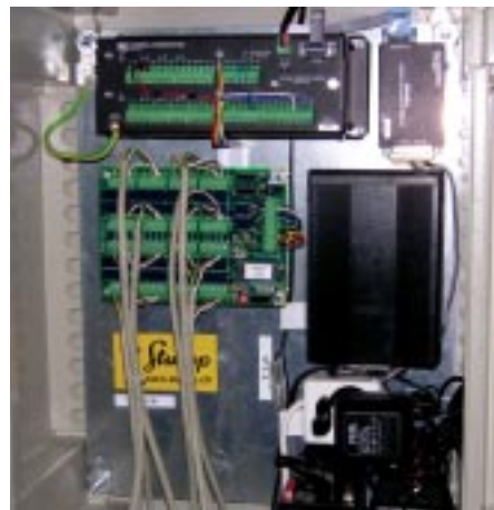
Bottighofen: datalogger per tiltometro
