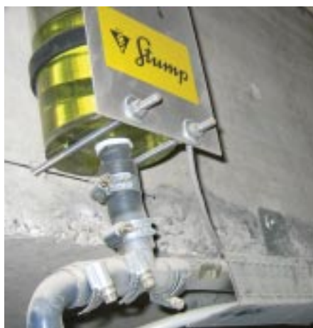
Bundes Medienhaus à Berne: nivelle électronique à vases communicants
