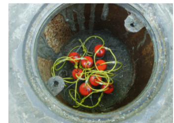
Bild 2: Beispiel Endzustand mit 8 Messrohren
